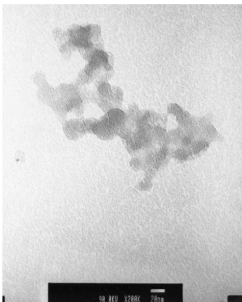
**Imagen 37** Micrografía tomada del microscopio de transmisión electrónica, reducción con  $\text{NaBH}_4$  en Etilenglicol como disolvente.
