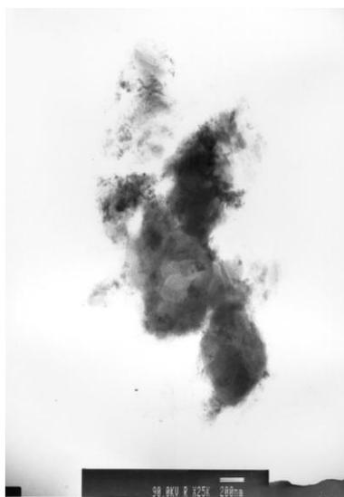
**Imagen 35** Micrografía tomada del microscopio de transmisión electrónica, reducción con  $\text{NaBH}_4$  en Etilenglicol como disolvente.
