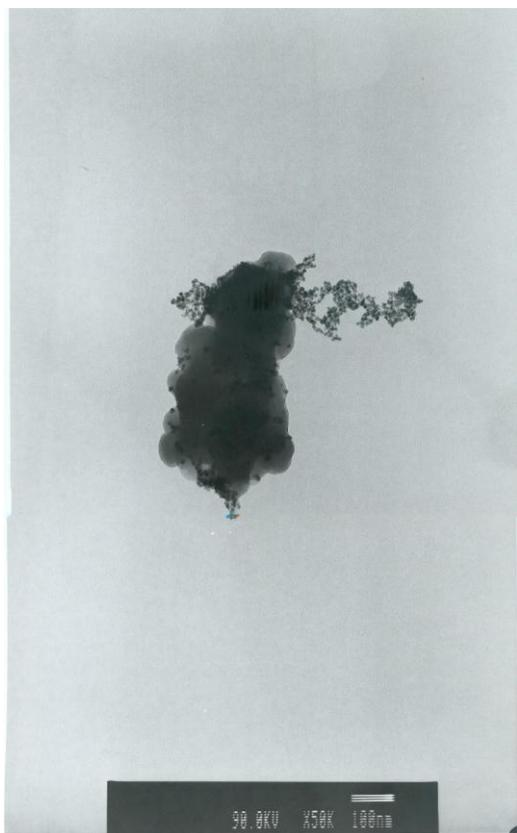
**Imagen 45** Micrografía tomada del microscopio de transmisión electrónica de la muestra de reducción asistida con radiación ultrasónica en etilenglicol como disolvente.
