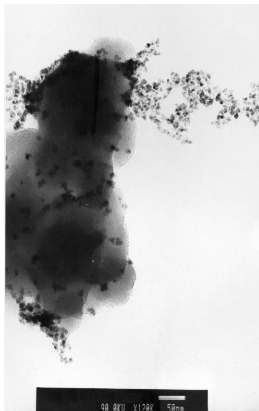
**Imagen 46** Micrografía tomada del microscopio de transmisión electrónica de la muestra de reducción asistida con radiación ultrasónica en etilenglicol como disolvente. Amplificación de un campo de la **Imagen 45**.
