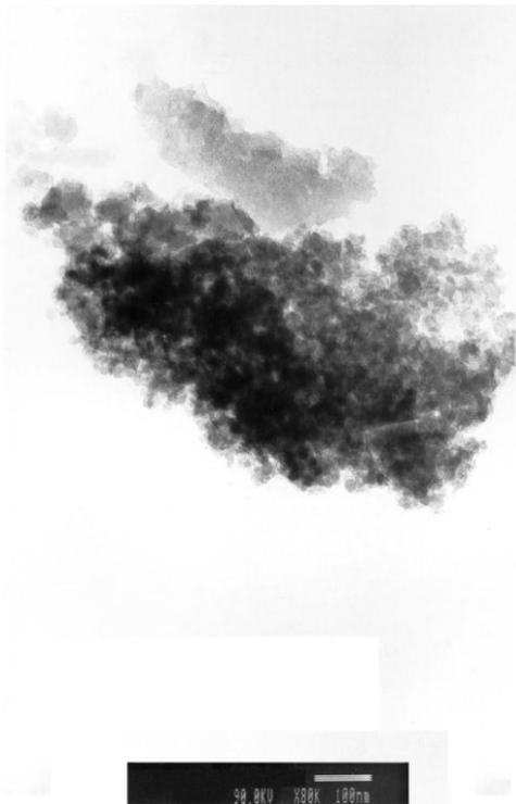
**Imagen 24** Micrografía tomada del microscopio de transmisión electrónica, reducción asistida con radiación ultrasónica en DMF como disolvente.
