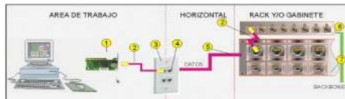
Figura 9.1 Estructura básica del cableado horizontal
