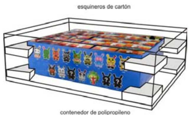
Esquema del contenedor y soportes para embalaje de los Dunnys
