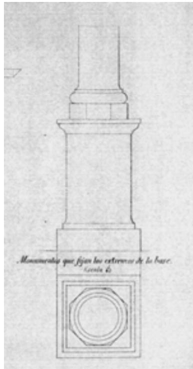
16. Esquema de un monumento de Ingeniería, con una vista de la sección inferior, aquella que se cimienta, siendo ésta la tarea más importante al colocar una marca monumental, se destaca la parte más baja y la base; la columna sólo se sugiere. El ejemplo corresponde a un monumento con materiales duraderos. Publicada en Orozco y Berra, Manuel, *Memoria para la carta hidrográfica*, esquema desplegable entre pp.30-31
