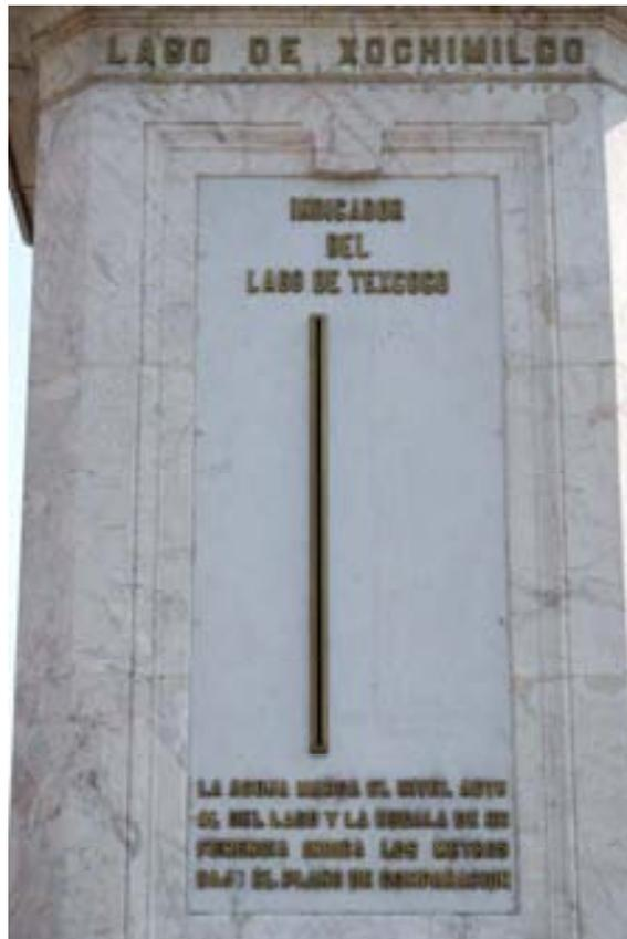
8. Indicador del lago de Texcoco que consta de un asta que tenía incrustada una punta indicadora que se desplazaba hacia los extremos, a la manera de vernier; a la derecha está grabada la escala de medida.
