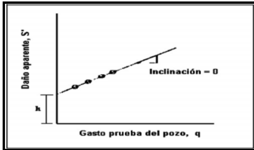
Figura 4.7 Determinación en campo del efecto de daño y coeficiente no-Darciano a partir de una prueba múltiple de gastos en el pozo (Lozano y Pérez, 2004) 19 .
