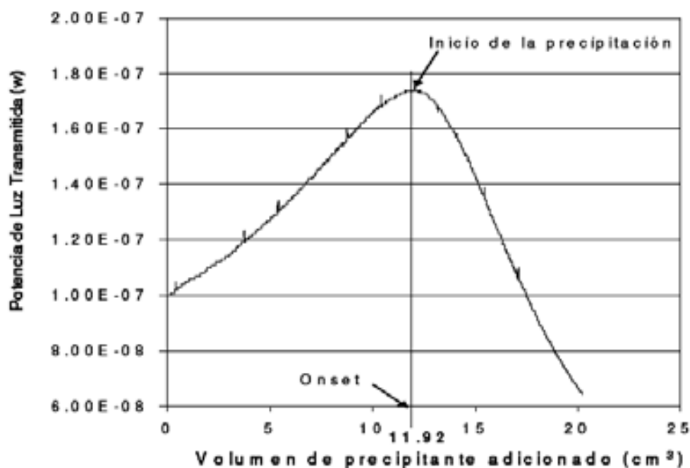
Figura 6.8 Gráfica resultante del experimento de adición de un precipitante (IMP, 2007) 24 .
