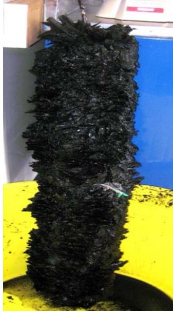
Figura 6. Escobillón formado con la cinta de polietileno utilizado como medio de soporte.
