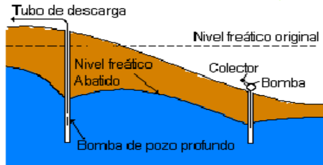
figura 3.2.2.1 Pozo profundo (ref 15)
