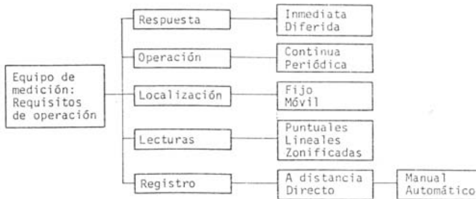
figura 5.1.3.2 Clasificación de los equipos de medición en función de los requisitos de operación (CFE, Manual de Diseño Obras civiles, 1983)
