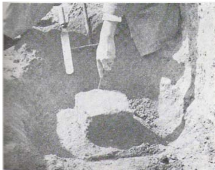
figura 2.1.1.1 Pozo a cielo abierto (CNA 1990)
