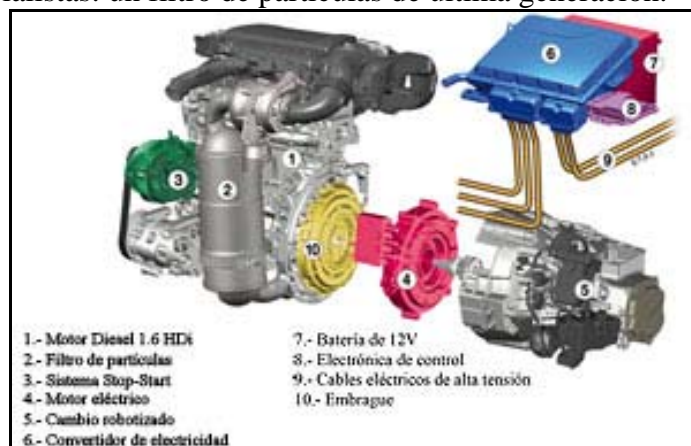
Figura 1.8 Componentes del sistema híbrido diesel-eléctrico.
