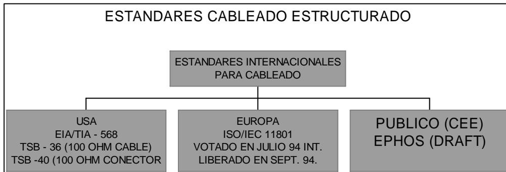
Figura V.1. Estándares de Cableado Estructurado.
