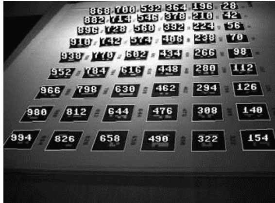
Figura 2.3: ARTag: Detección de marcas en condiciones de iluminación variable. Imagen tomada de [Fia05].
