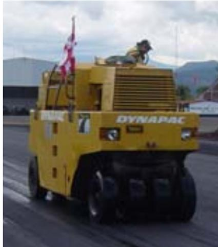
La segunda compactación se considera preferible los rodillos neumáticos adecuados para alcanzar un mínimo de 95% del peso volumétrico máximo, que deben seguir a la compactación inicial tan de cerca como sea posible y mientras la mezcla está aún a una temperatura que permita alcanzar la máxima densidad.
