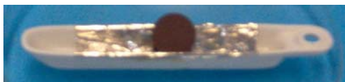
Fig. 19. Pastilla de TbMnO_3 , en una nave de porcelana sobre una laminilla de platino.
