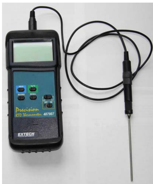
Figura 4.3: Termómetro digital utilizado en las mediciones de temperatura en las técnicas de turbidimetría y tensión superficial.
