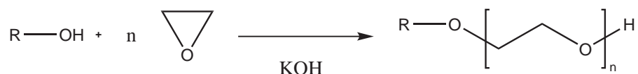
Figura 2.6: Reacción de etoxilación de un alcohol para la síntesis de un tensoactivo. R corresponde a la parte hidrofóbica, una base, en este caso KOH es usado como catalizador. El iniciador de la reacción es el alcohol.
