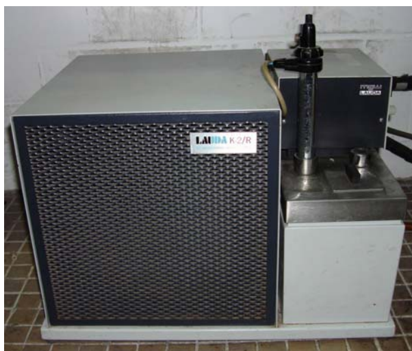
Figura 4.1: Baño utilizado como control de temperatura en la medición de la tensión superficial y en la técnica de turbidimetría.
