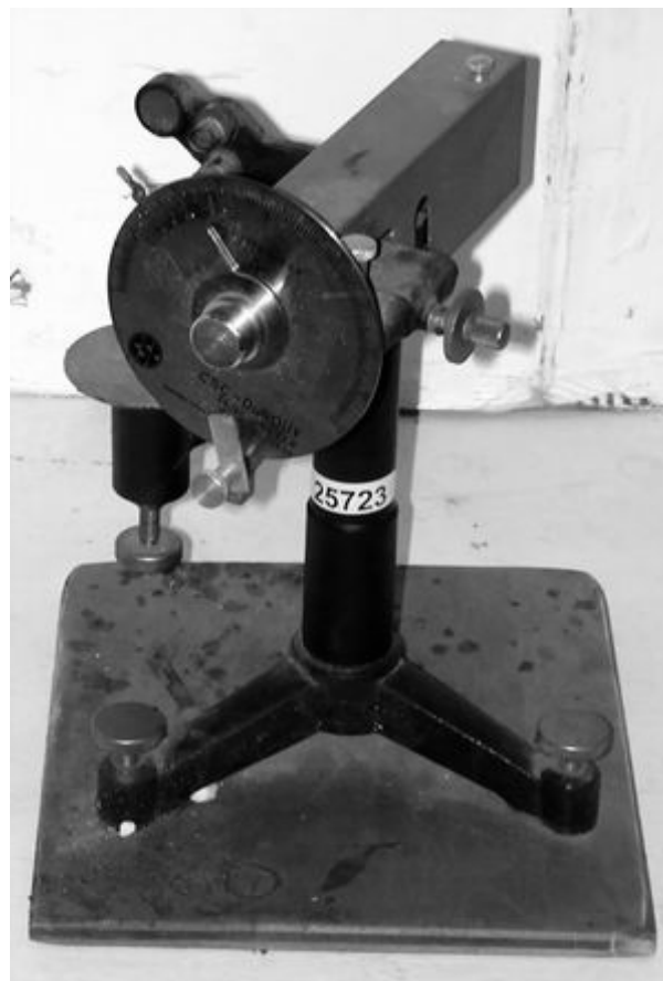
Figura 1.3: Balanza de du Noüy o balanza de torsión usada para determinar la tensión superficial o interfacial. ( http://www.labequip.com/itemcatalog/stkno/25723/Cenco-Dunouy-70535/Surface-Tension-Tensiometer.html .)
