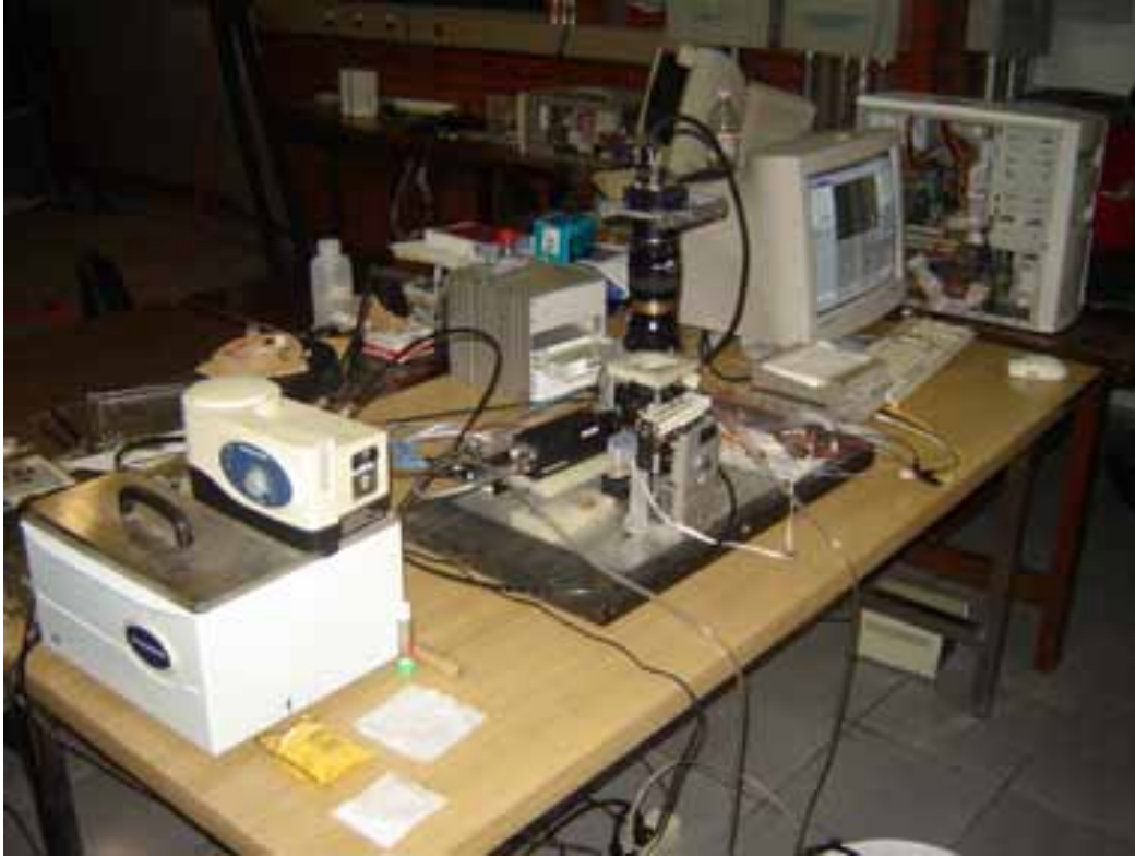
Figura 2.1: Equipo experimental para estudiar la convección natural en una cavidad cilíndrica.
