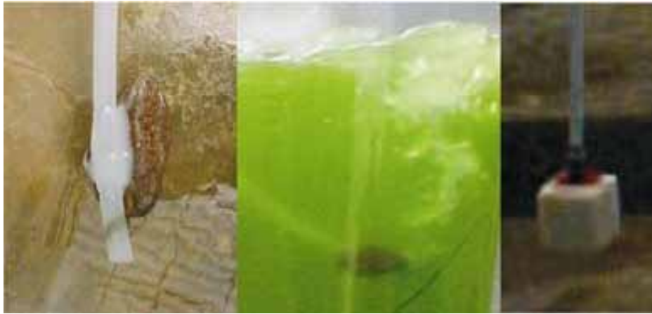
Fig. 12 mangueras pegadas con silicona a contrapesos para cultivos de microalga. Fig. 13 Difusores de aire colocados en el cultivo de rotíferos
