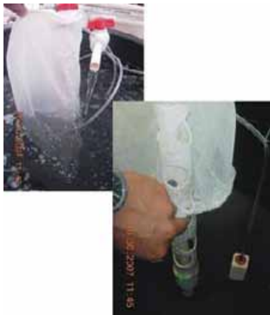
Fig. 22 Sistema de filtrado para flujo continuo.
