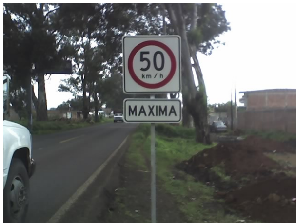
Fig. 5.13 Señal restrictiva (SR-9 velocidad máxima)
