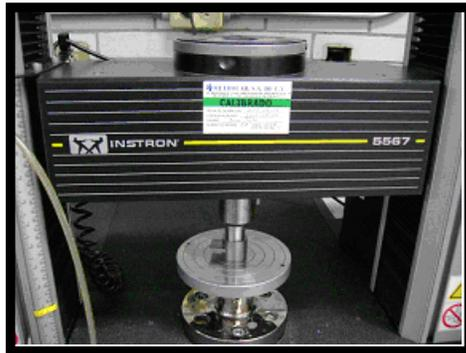
Fig. 23 Detalle de la Máquina universal de pruebas mecánicas Instron
