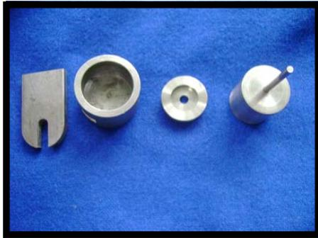
Fig. 22 Molde para fabricar muestras para pruebas físicas 4.3.3 especificación ANSI/ADA No. 1 1977
