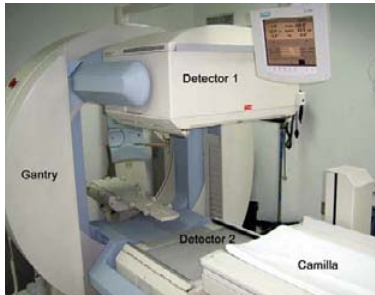
Figura 1.5. Cámara gamma de doble detector modelo e.cam® de la compañía Siemens, ubicada en el
