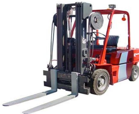
Figura 1.4 Montacargas [22].
