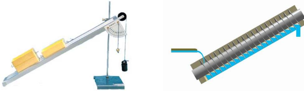
Figura 1.2 Plano inclinado y tornillo de Arquímedes [16] [17].
