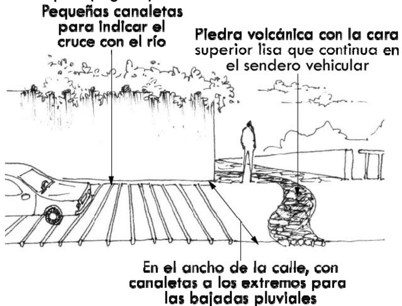
Fig.50 Intervención en pavimento para indicar el paseo y disminuir la velocidad del automóvil.
