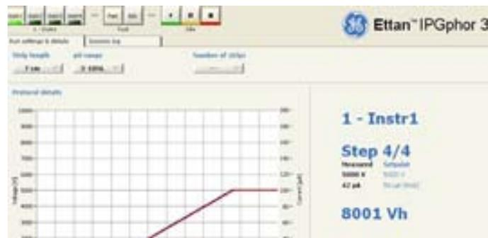
**Figura 27** : Curva Voltaje vs >Tiempo del IEF de las proteínas del extracto total de células MCF-7, Hs578T, y Hs578Bst.
