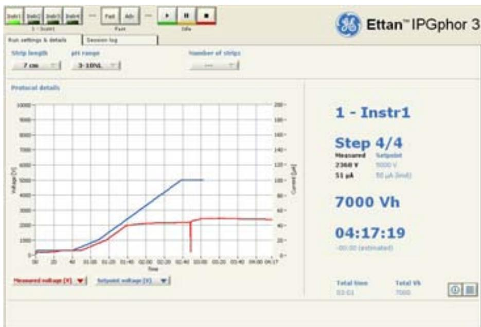
Figura 22. EttanIPGphor3 de General Electric, gráfica de Voltage vs Tiempo.
