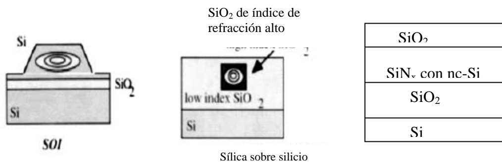
Fig. 2.7 Diferentes estructuras de guías de onda. La guía de onda fabricada en este proyecto (extrema derecha) ofrece la película de SiN x como medio de propagación.
