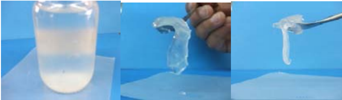
Figura 9: Mezcla 0.025% gelana con 0.75% gelatina. De izquierda a derecha; solución, gel fase superior, gel fase inferior.
