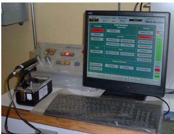
Figura 37. Consola de Control de todo el sistema y de las fuentes del irradiador Gammabeam GB651 PT
