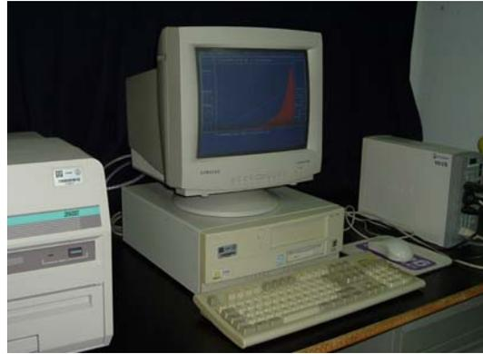
Figura 18. Equipo de Termoluminiscencia Harshaw 3500 con software. A la derecha se ve acoplado con la computadora y software asociado
