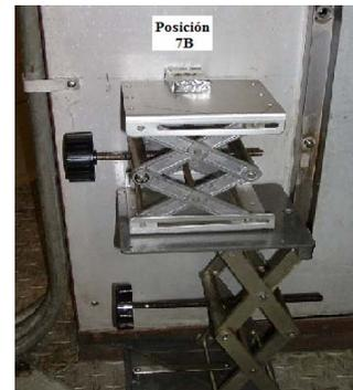
Figura 17. Posición de irradiación (flecha) de las muestras en la cámara de irradiación del irradiator Gammabeam 651PT del ICN UNAM. La fotografía muestra las posiciones de irradiación
