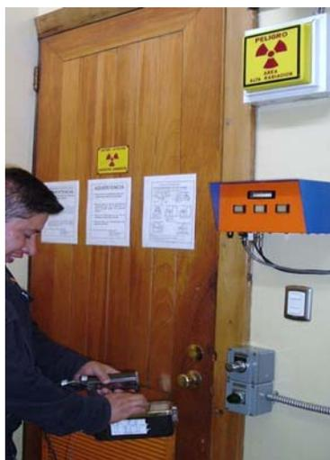
Figura 39. Señalización de presencia de radiación, enseguida la caja de verificación de niveles de radiación, fuente de prueba y funcionamiento del monitor portátil del operador.
