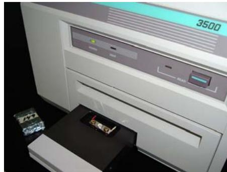
Figura 19. Plancheta del equipo Harshaw 3500 para el disco con los poliminerales
