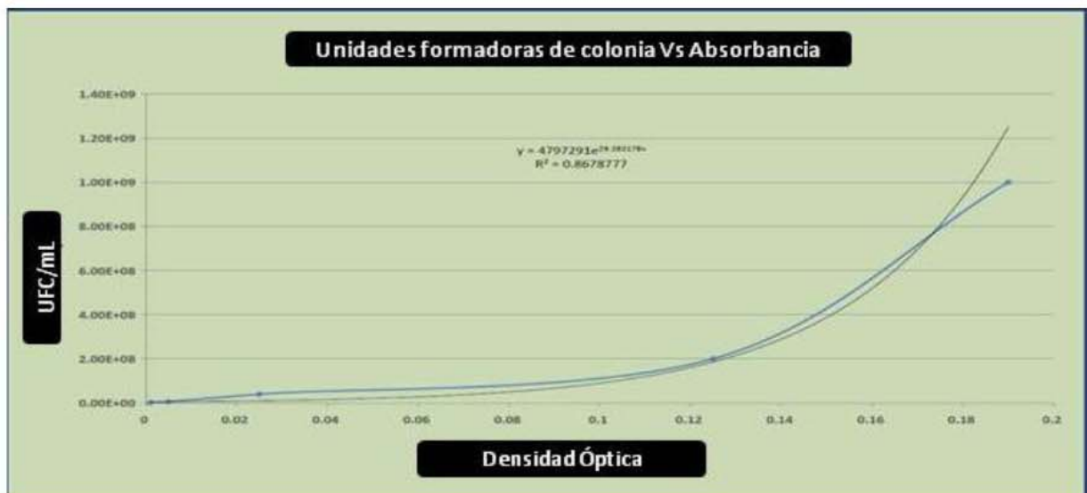
Fig. 4 Se muestra la curva de crecimiento de Salmonella typhimurium WG49. Nótese la densidad óptima del cultivo para inóculo se alcanza a una absorbancia de 0.12 OD( \approx 120 minutos de incubación a 37C en medio TYGB).
