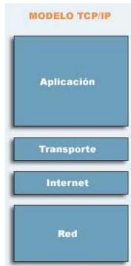
**Figura 2. Modelo TCP/IP**
