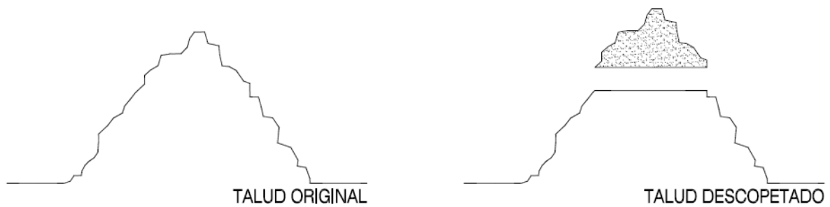
Imagen 1.6.- Esquema de “descopetado” de un Talud. Fuente: D. R. © Arq. José Leonardo Castellanos Gaspar, 2008.
