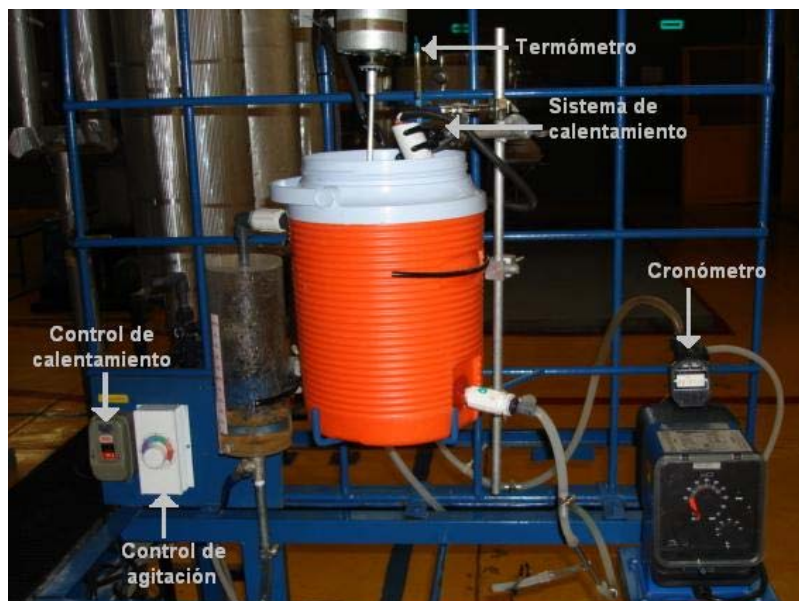
Figura 3.1 Equipo para balances de materia y energía a régimen no permanente visto de frente 1
