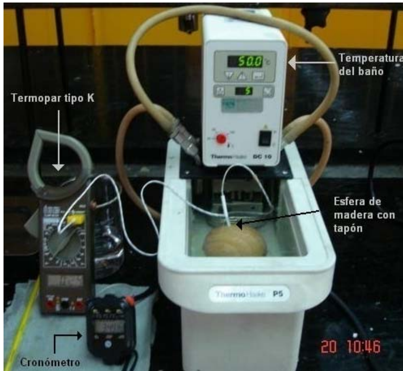
Figura 4.4 Calentamiento de la esfera de madera a 50 °C con tapón
