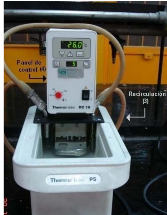
Figura 4.1 y 4.2 Llenado (izquierda) y encendido (derecha) del baño de temperatura
