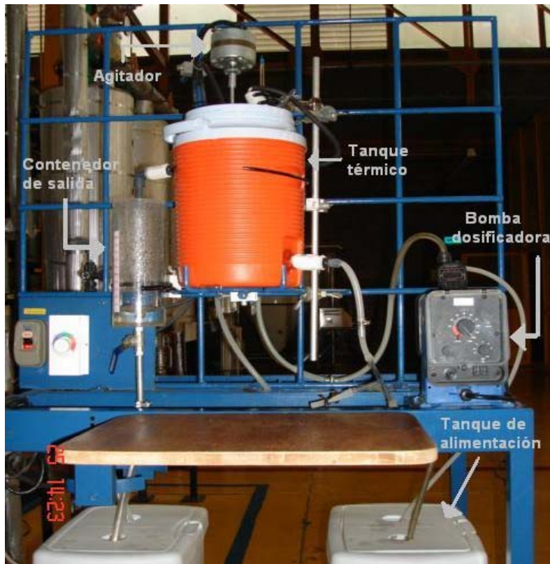
Figura 3.2 Equipo para balances de materia y energía a régimen no permanente visto de frente 2
