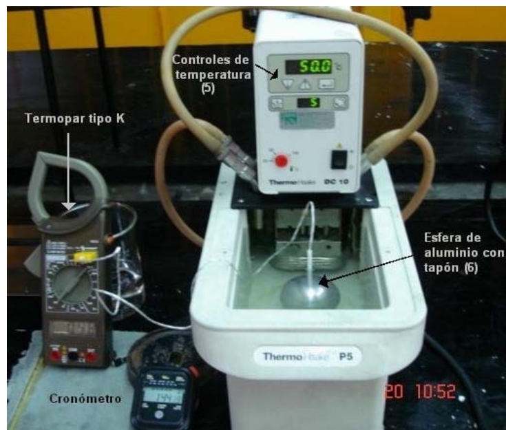
Figura 4.3 Calentamiento de la esfera de aluminio a 50 °C con tapón
