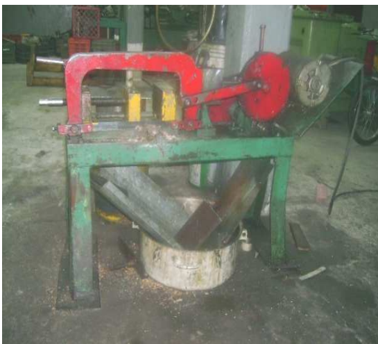
Figura 2.25. Cortadora mecánica a 127 V.
