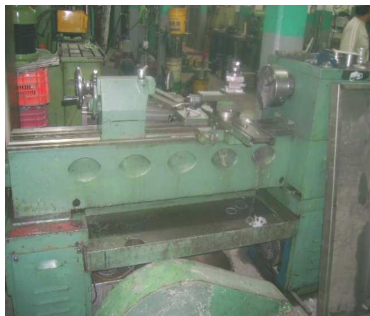
Figura 2.22. Torno horizontal semiautomático a 220 V.
