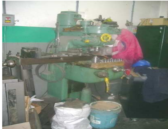
Figura 2.18. Fresa vertical a 220 V fuera de servicio.
