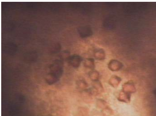
figura 31. Cristales obtenidos sobre un electrodo de Pt mediante los voltamperogramas observados en la figura 29. Ferritina 20 mg/mL, \text{CdSO}_4 0.1 M y (\text{NH}_4)_2\text{SO}_4 0.5 M.
