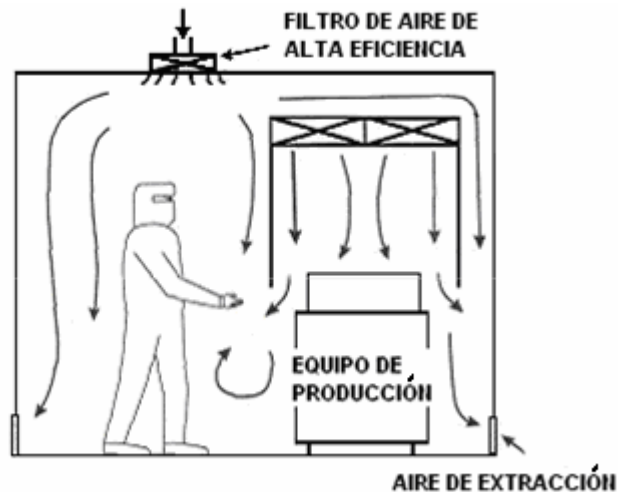
Figura 2.16 Cuarto limpio con flujo mezclado y con protección para áreas de proceso crítico
