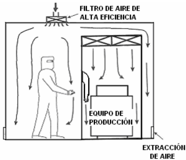
Figura 2.17 Cuarto limpio con aislador
