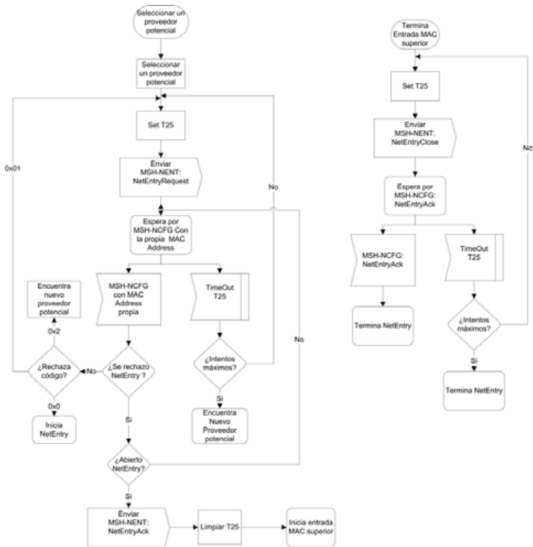
Figura 4.7: Sincronización y entrada de un nuevo nodo en red Mesh- 2da parte
