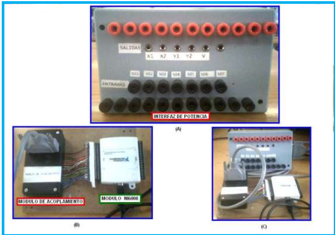
Fig. 2.18 A) Interfaz de potencia, B) Módulo de acoplamiento y la tarjeta NI USB6008, C) Acoplamiento de los tres componentes
