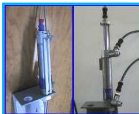
Figura. 1.5 Pistón doble efecto con ventosa
