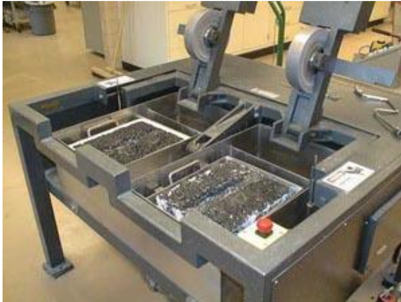
Rueda de Hamburgo. Fuente: http://www.fhwa.dot.gov/pavement/asphalt/labs/mixtures/hamburg.cfm
