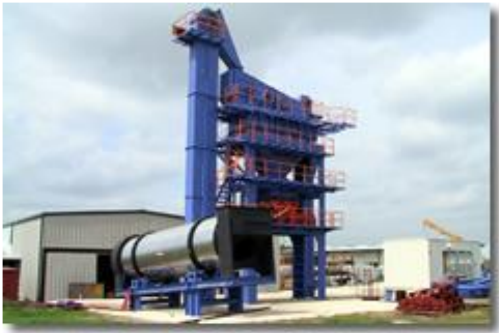
Planta de dosificación o bachas
