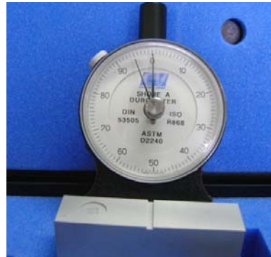
Figura 7 Se midió la dureza con un durómetro modelo 306L.
