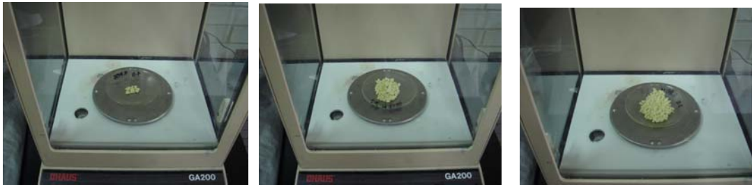
Figuras 24, 25, 26, 27, 28, 29,30. Medición del peso de las partículas de los diferentes tamices 5.6,4.0,2.8,2.0,0.85 y 0.25.
