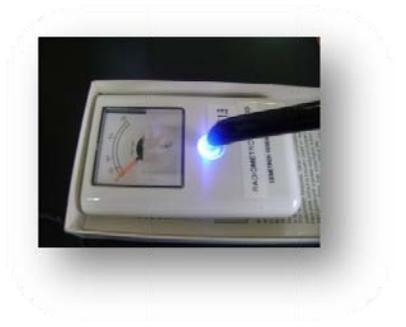
Fig.26 Comprobación del calor emitido por la lámpara
