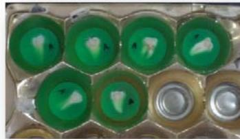
Fig 41,42 Colocación de las muestras en un recipiente con agua desionizada
