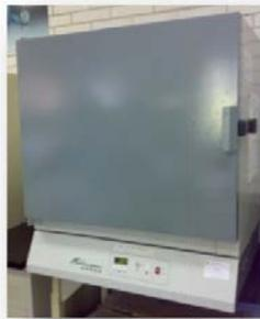
Fig.5 Horno para las muestras con una temperatura a 37°C
