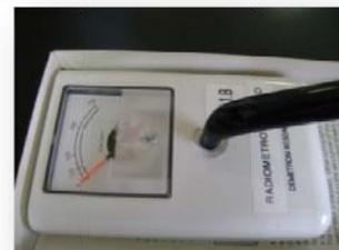
Fig. 9 Radiómetro L.E.D para probar la longitud de onda  $\text{mw/cm}^2$
