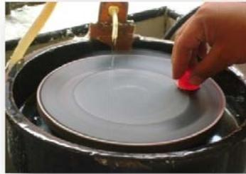
fig. 20 Uso de la Pulidora p(Buehler Ltd. 2120 Greenwood St. Evanston Illinois, USA) para el desgaste de las muestras con el papel abrasivo del N°600 y 320
