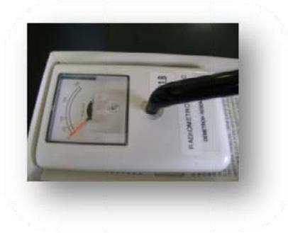
Fig.24 radiómetro (Demetron Corp. USA)
