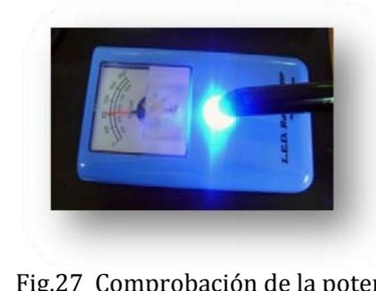
Fig.27 Comprobación de la potencia de luz emitida por la lámpara.
