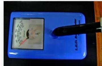
Fig.7 Radiómetro Demetron Corp. USA).de la lámpara  $\text{mw/cm}^2$
