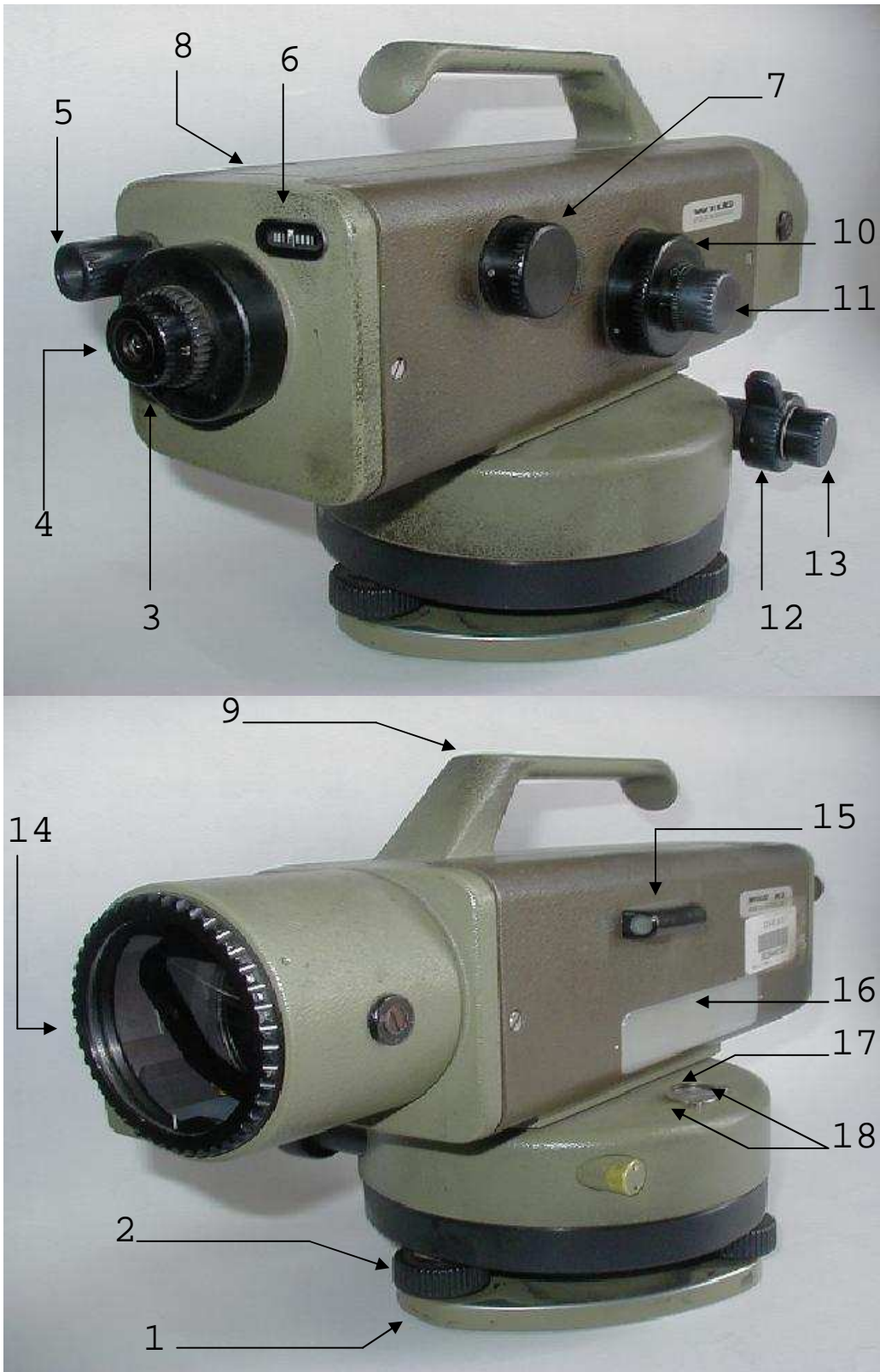
Gráfica 2.1.1 Partes principales del Nivel N-3
