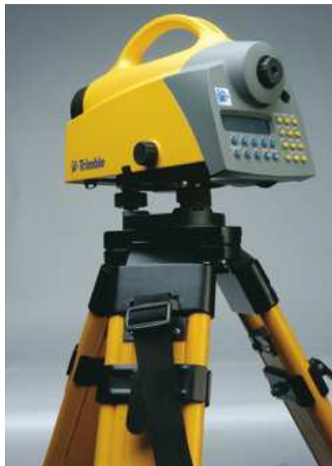
Gráfica 6.2.2 Nivel Electrónico DiNi12 de Trimble sobre Trípode
