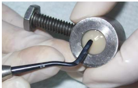
Fig. 9 Condensación de la resina en el hacedor de muestras
