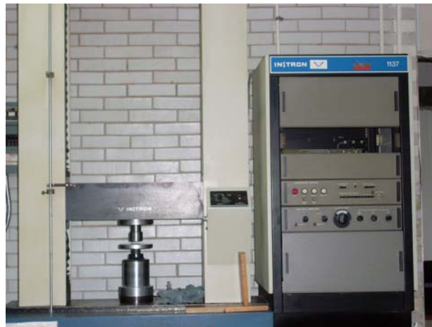
Fig. 7 Máquina universal de pruebas mecánicas Instron modelo 55-67 Fuente directa
