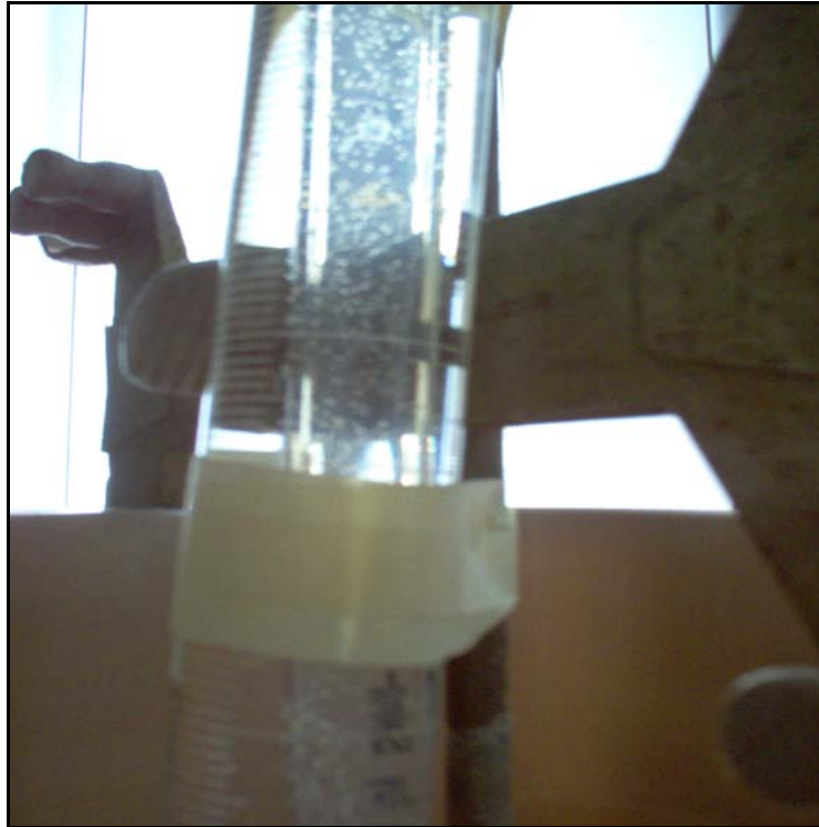
Figura 5.18 Evidencia de producción de biogás
