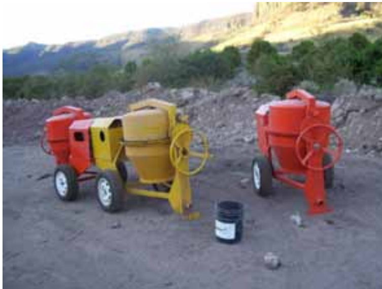
Foto 4.17 Revolvedoras de concreto.
