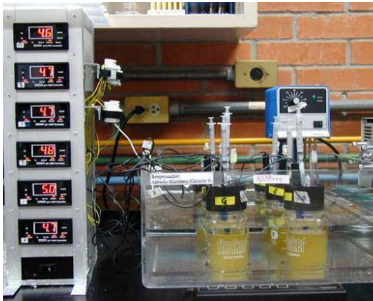
Figura 1. Sistema de minifermentadores (fleakers) utilizados en este proyecto.
