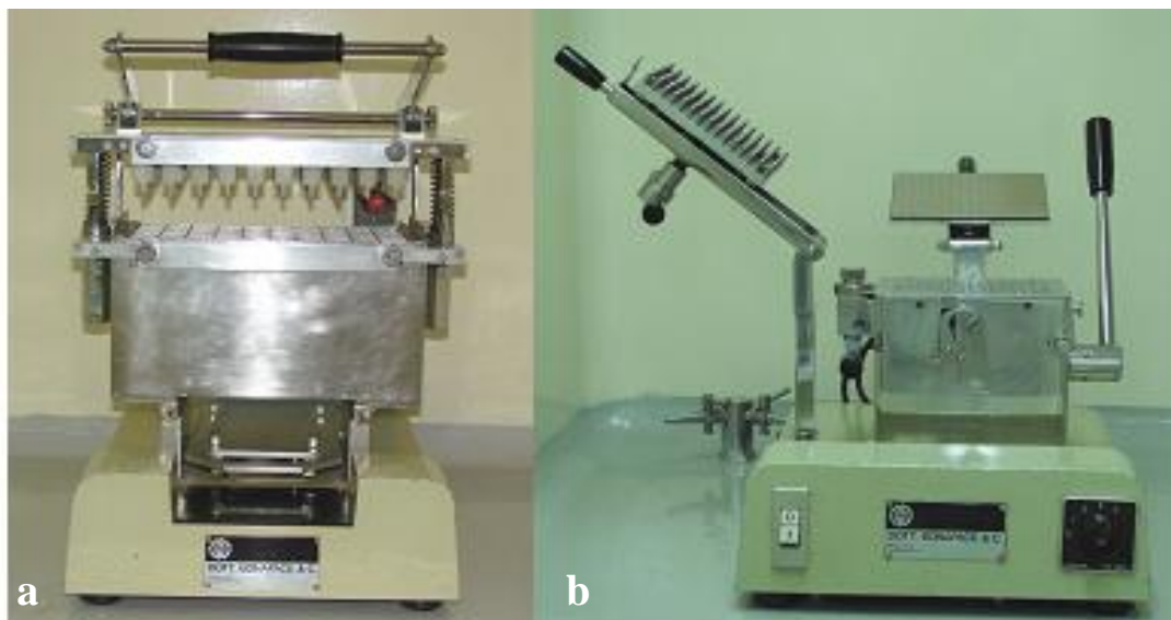
Figura 1. Vista general de la encapsuladora marca BONAPACE: orientadora (a) y llenadora (b).
