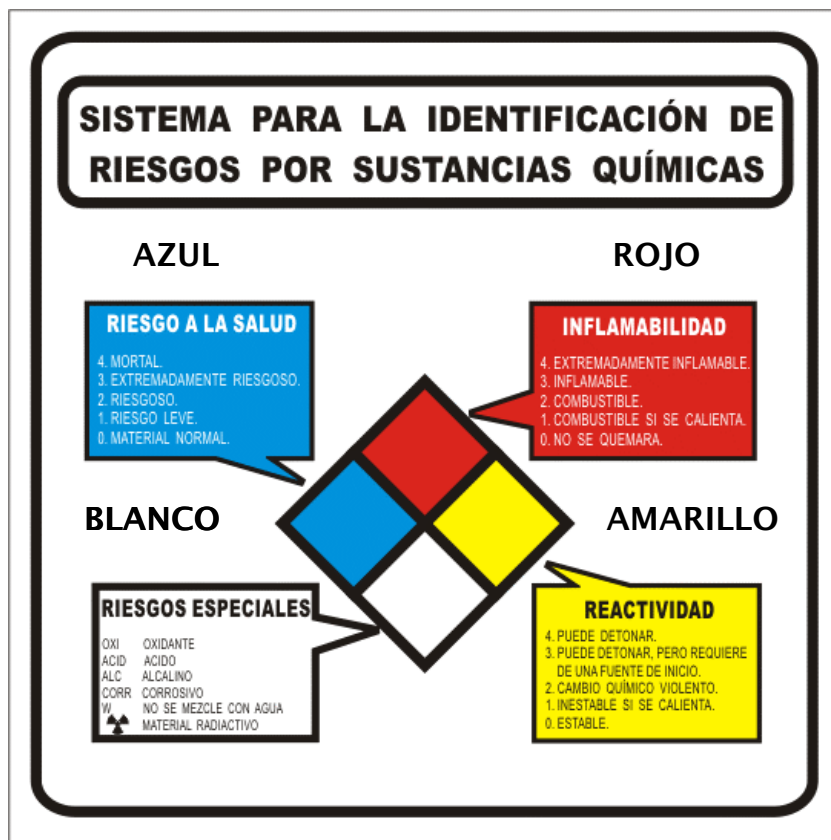
Sistema de Identificación de Riesgos, NFPA.
