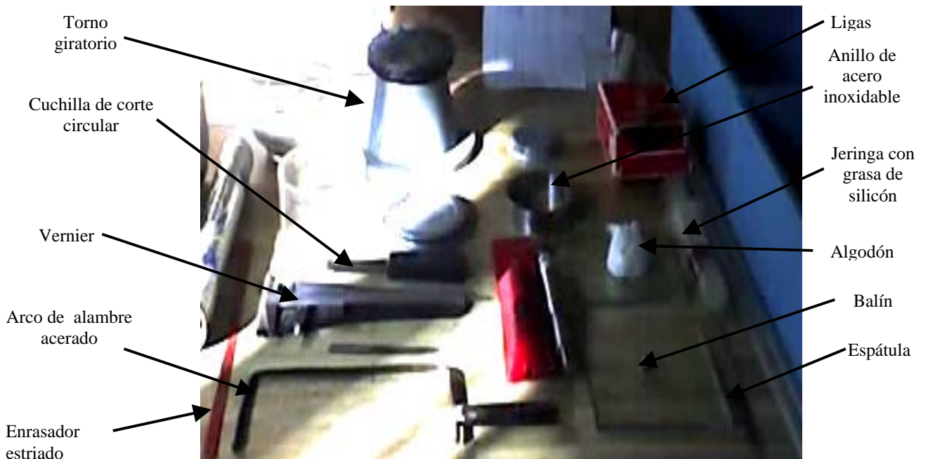
Foto 3 Dispositivos para labrado de muestra de suelo
