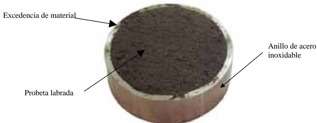
Fotografía 5 Muestra de suelo contenida en el anillo de consolidación
