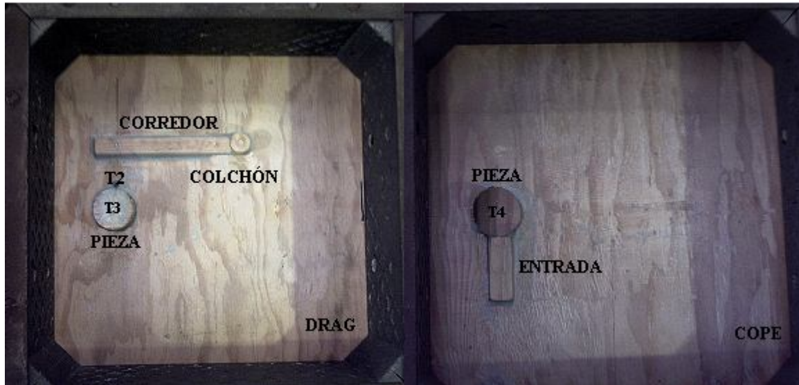
Figura 4.3. Placa modelo conteniendo la pieza y los componentes del sistema de colada.
