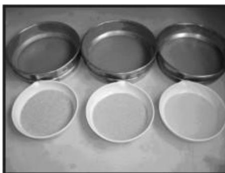
Figura 5.20. Mallas utilizadas para la separación de los fragmentos de roca por tamaño de grano. De izquierda a derecha: malla 18, 35 y 60.
