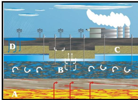
Figura 2.1. Esquema general de un sistema geotérmico. A) fuente primaria de calor; B) reservorio geotérmico; C) cobertura impermeable; D) zona de recarga.
