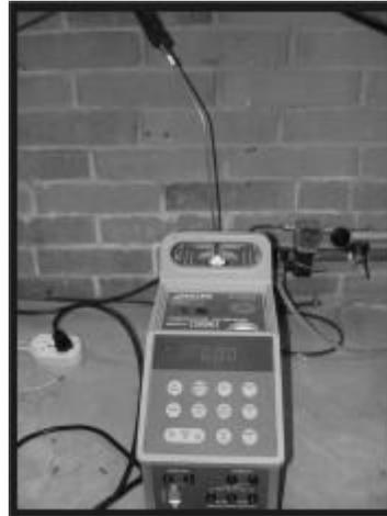
Figura 5.10. Calibrador de termopares utilizado para la calibración del termopar del reactor.
