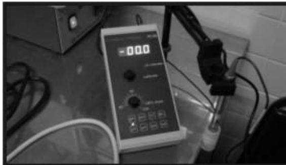
Figura 5.21. Dispositivo para la medición del pH y  $\lambda$  utilizado para la caracterización inicial del agua destilada y desionizada usada como reactante en los experimentos de interacción fluido-roca.
