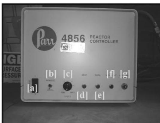
Figura 5.9. Controlador electrónico (parte frontal). [a] Botón de apagado-encendido del motor de agitación, [b] modo de operación de la agitación (manual o automática), [c] regulador manual de las rpm del motor, [d] indicador del sistema de calentamiento, [e] indicador del sistema de enfriamiento, [f] indicador de seguridad, [g] botón para reiniciar el controlador en caso de una falla.
