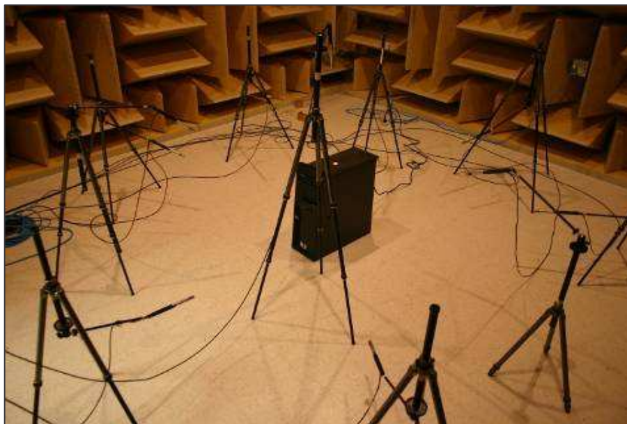
Fig. 2: Arreglo hemisférico de diez micrófonos dentro de una cámara semianecoica.
