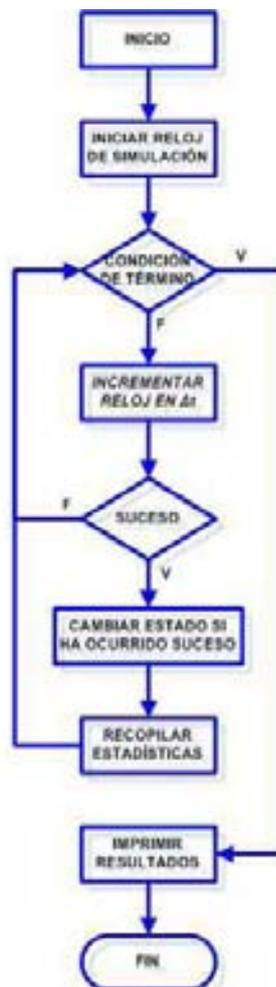
Figura 2.3: Diagrama de simulación orientada a sucesos
