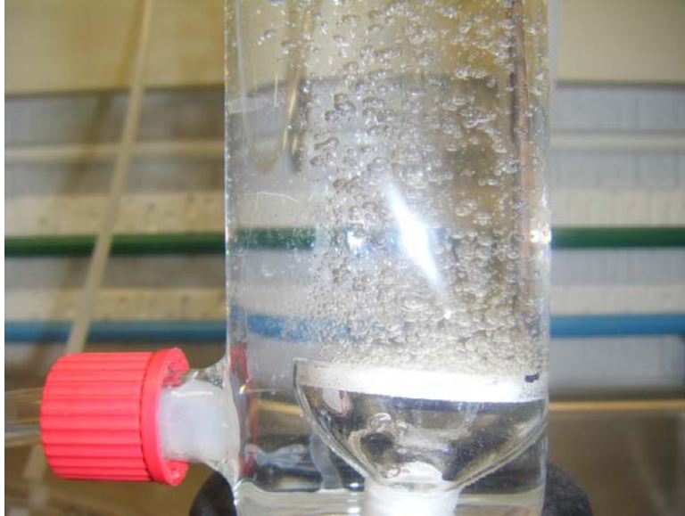
Figura A4 Difusor de placa porosa de 10 a 15 \mu\text{m}
