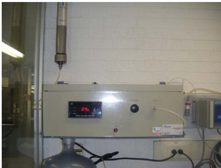
Figura A3 Analizador de ozono en fase gaseosa
