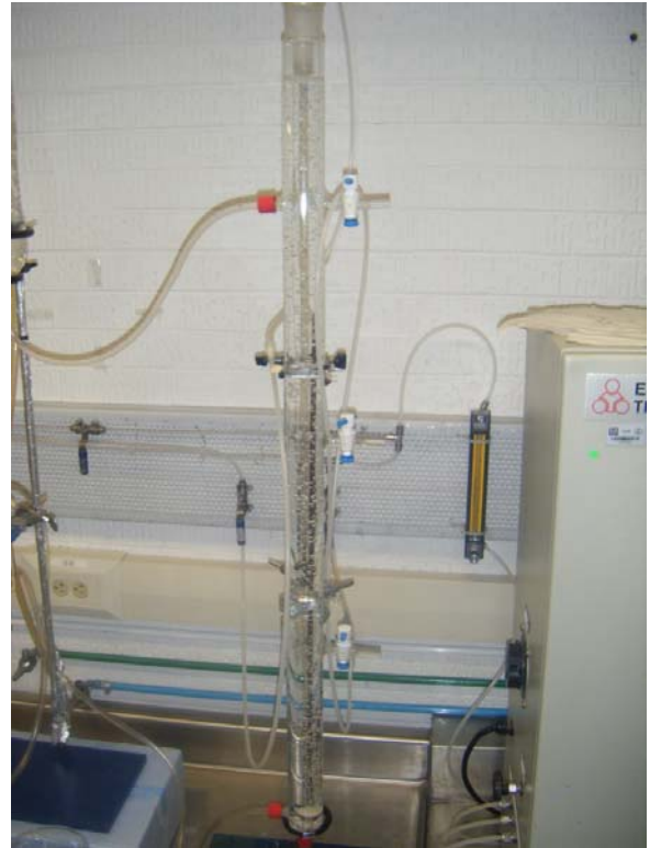
Figura A2 Columna de burbujeo
