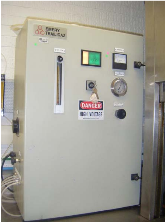
Figura A1 Generador de ozono (Emery Trailigaz)
