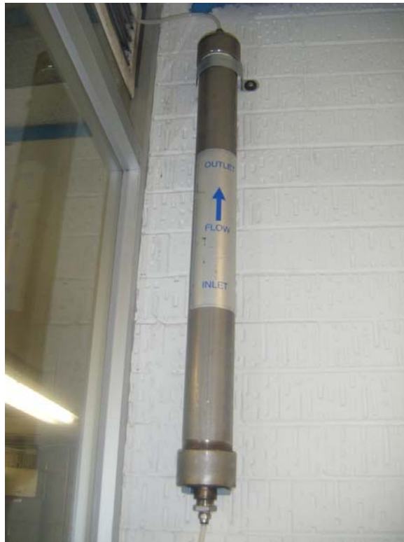
Figura A5 Destructor de ozono
