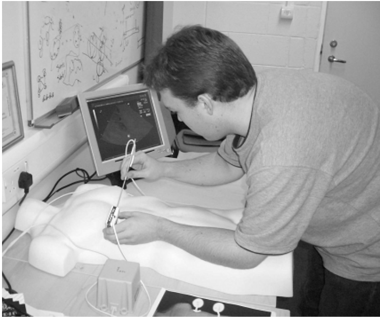
Figura 1.3: Simulador de realidad virtual para entrenamiento de inserción de agujas guiadas por ultrasonido (Magee[35, pág. 302]).
