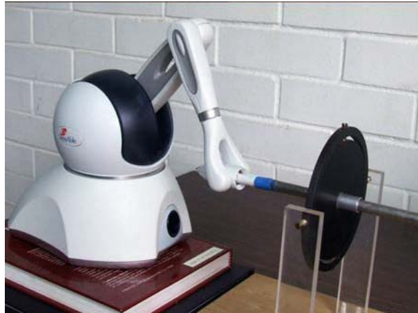
Figura 2.10: PHANTOM Omni® . Sensible Technologies 2007 . El dispositivo háptico tiene la capacidad de registrar los movimientos del usuario y representar un efecto de oposición ante ciertas condiciones definidas en el programa de simulación.
